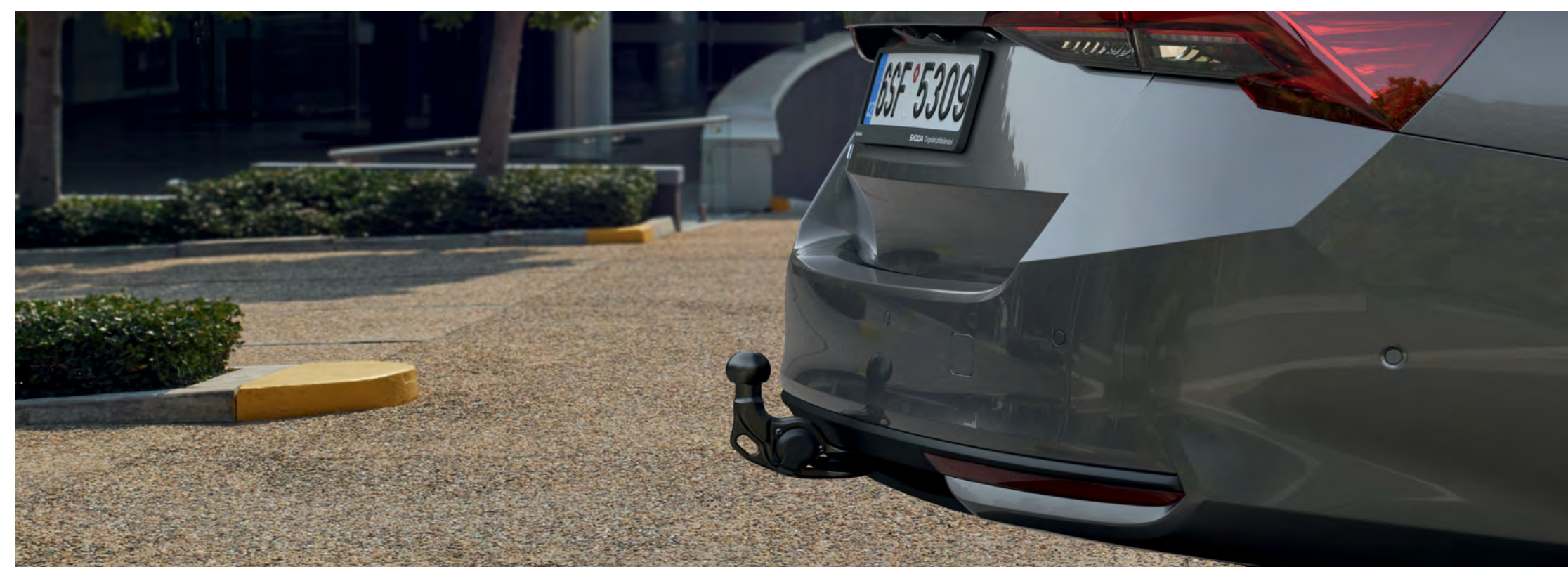
Tažné zařízení sklopné, elektricky odjistitelné
