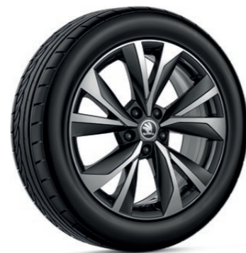
Corvus Kolo z lehké slitiny 7,0J × 18" ET45 pro pneumatiky s rozměry 215/50 R18 (4×2), 225/50 R18 (4×4) 57A 071 498M FL8 | černá metalická broušená
