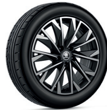
Hydrus Kolo z lehké slitiny 7,0J × 18" ET45 pro pneumatiky s rozměry 215/50 R18 (4×2), 225/50 R18 (4×4) 57A 071 498Q ZG6 | černá matná broušená
