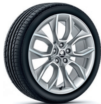
Crater Kolo z lehké slitiny 8,0J × 19" ET45 pro pneumatiky s rozměry 225/40 R19 (4×2), 225/45 R19 (4×4) 57A 071 499A 8Z8 | stříbrná metalická broušená
