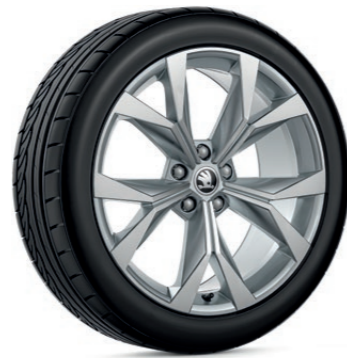
Cetus Kolo z lehké slitiny 8,0J × 19" ET45 pro pneumatiky s rozměry 225/40 R19 (4×2), 225/45 R19 (4×4) 57A 071 499D 8Z8 | stříbrná metalická broušená
